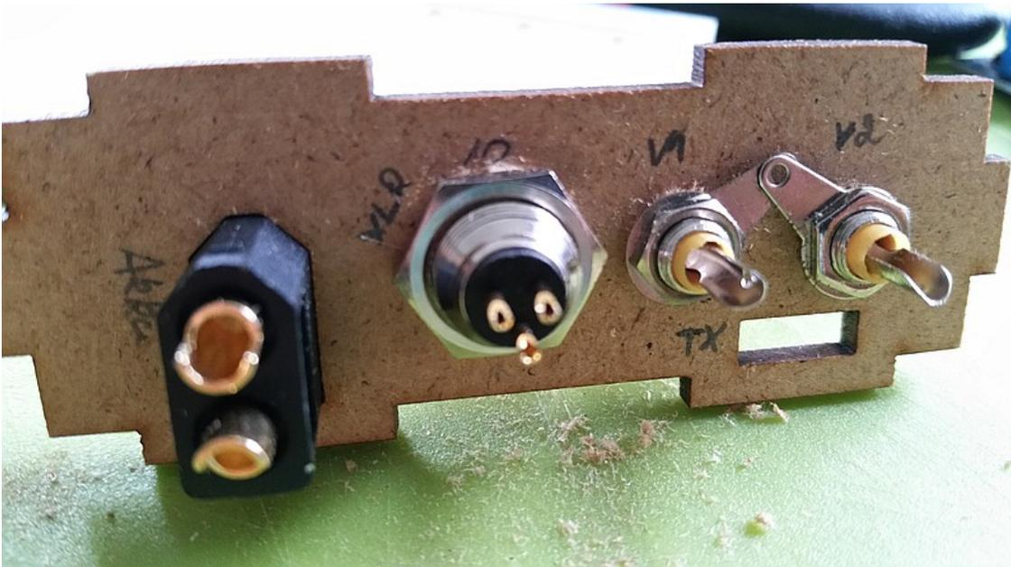
Servobuchse und XT60 wurden mit Epoxy gesichert:
